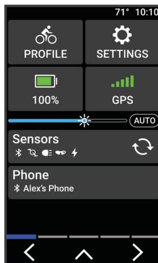
Появится виджет настроек. Мигающий значок указывает на то, что устройство выполняет поиск сигнала. Непрерывно отображающийся значок указывает на то, что сигнал найден или датчик подключен. Для изменения настроек можно выбрать любой значок.
