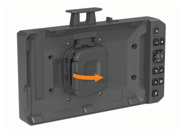
**СОВЕТ.** необходимо сохранить защитную крышку для использования в будущем. Используйте защитную крышку при извлечении устройства из док-станции.
