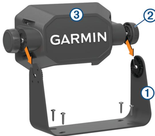
2 Сверлом соответствующего диаметра для крепежного оборудования просверлите направляющие отверстия.
