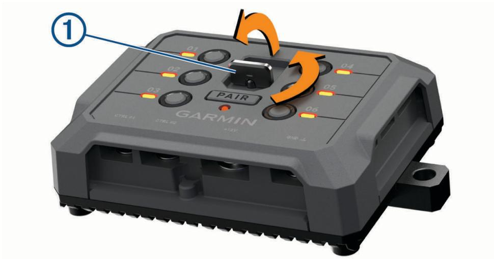
2 Снимите переднюю крышку с устройства.
