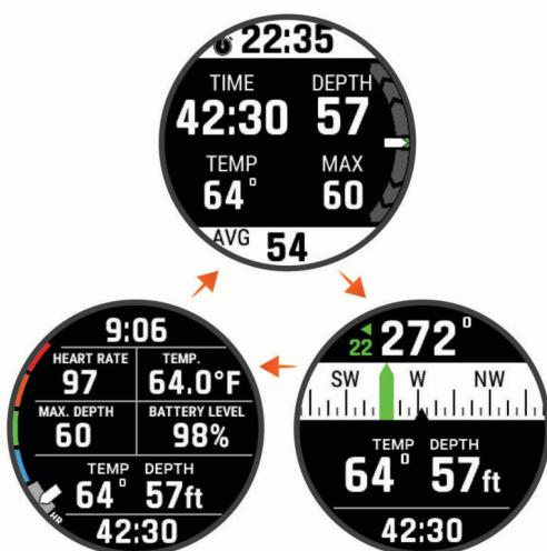
**Секундомер для дайвинга:** отображает секундомер времени на максимальной глубине; текущую, максимальную и среднюю глубину, а также скорость подъема или погружения ([Использование секундомера датчика погружения](#), стр. 21).
