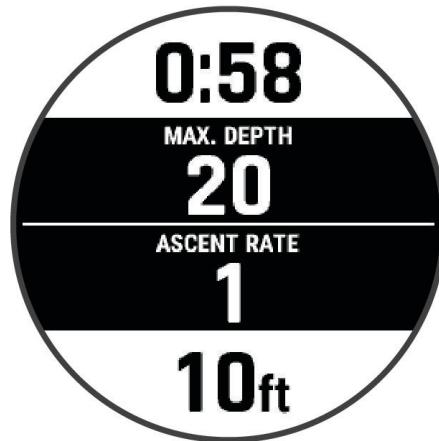
**Экран данных погружения:** отображение информации о текущем погружении, включая прошедшее время, текущую и максимальную глубину, а также скорость подъема или погружения. Можно редактировать компоновку экрана и поля данных ([Настройка экранов данных, стр. 119](#)).
