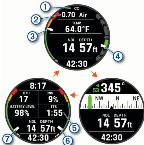
**Экран основных данных:** содержит основные данные погружения, включая дыхательный газ и скорость подъема или погружения.
