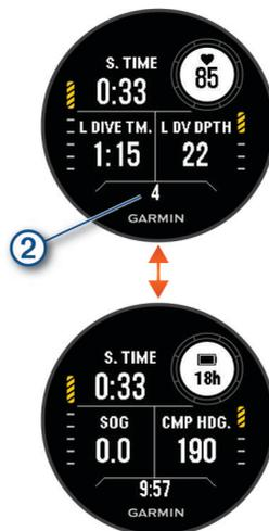
**Экран интервала между погружениями:** отображение текущего времени интервала между погружениями, а также прошедшего времени, максимальной глубины и температуры при последнем погружении в режиме апноэ. Поля данных можно редактировать.
