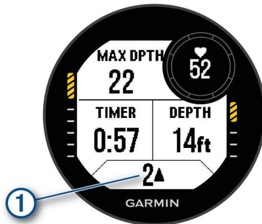
**Экран данных погружения:** отображение информации о текущем погружении, включая прошедшее время, текущую и максимальную глубину, частоту пульса, а также скорость всплытия или погружения. Можно изменить три поля данных (*Настройка экранов данных, стр. 48*).
