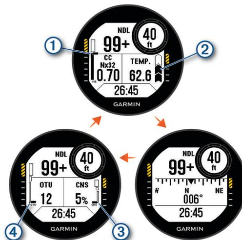
**Экран основных данных:** отображение основных данных о погружении, включая дыхательный газ, парциальное давление кислорода (P<sub>O2</sub>) и скорость всплытия. Одно из полей данных можно редактировать.
