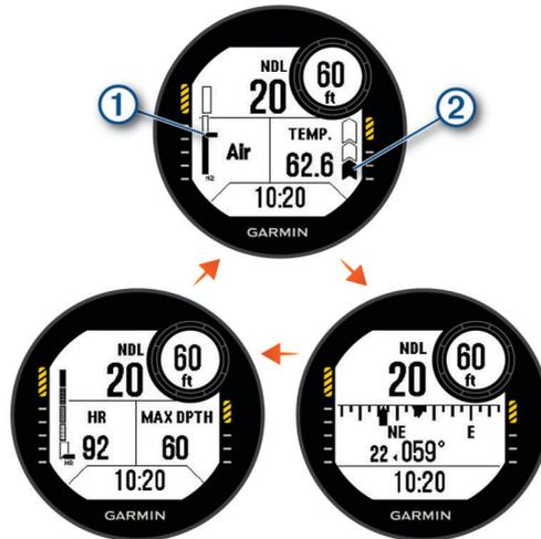
**Экран основных данных:** отображение основных данных о погружении, включая дыхательный газ, парциальное давление кислорода (PO2) и скорость всплытия. Одно из полей данных можно редактировать.
