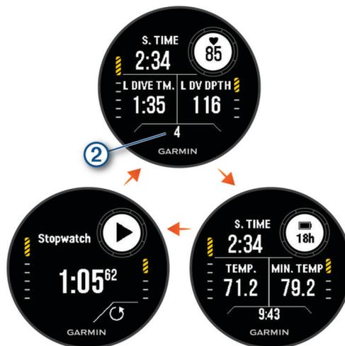
**Экран интервала между погружениями:** отображение текущего интервала между погружениями, частоты пульса и информации о последнем погружении. Поля данных можно редактировать.
