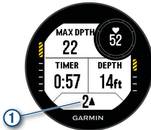
**Экран данных погружения:** отображение информации о текущем погружении, включая прошедшее время, текущую и максимальную глубину, частоту пульса, а также скорость подъема или погружения. Можно изменить три поля данных (*Настройка экранов данных, стр. 48*).
