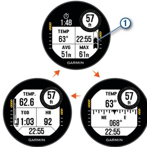
**Секундомер для дайвинга:** отображение секундомера, средней глубины, максимальной глубины, а также скорости всплытия (*Использование секундомера датчика погружения, стр. 21*).
